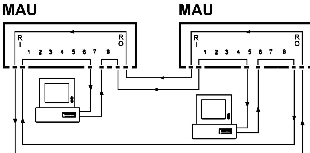
Le support utilisé est de la paire blindée (STP 150 $\Omega$ ) avec des connecteurs hermaphrodites. Des versions sur câble UTP 100 $\Omega$  et connecteurs RJ45 (paires 3-6, 4-5) sont apparues. Les distances permises sont de 100m pour les stations de 60 à 400m (2 km en fibre optique) entre MAU selon le type.
